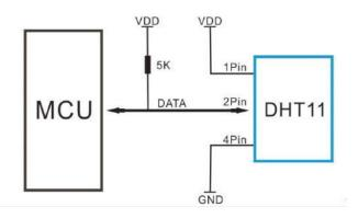
Fig 3.2: DHT11 pin configuration
